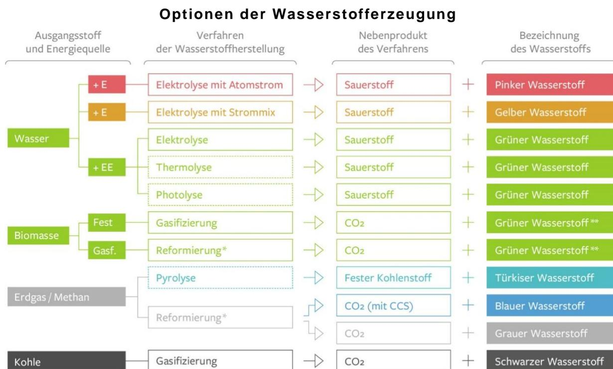
⋯: Noch nicht im industriellen Maßstab verfügbar \* Dampfreformierung/autotherme Reformierung EE = Erneuerbare Energie E = Energie CCS = Carbon Capture and Storage (Abscheidung und Speicherung von CO<sub>2</sub>) \*\* Mit Einschränkungen, siehe Tz. 31
